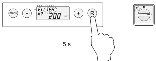
Nach dem Zurücksetzen des Filters erlischt der Text 'FILTER'. Die Leuchte am Stufenschalter ist wieder aus und im Display wird wieder die Betriebsart 'Betrieb' angezeigt.
