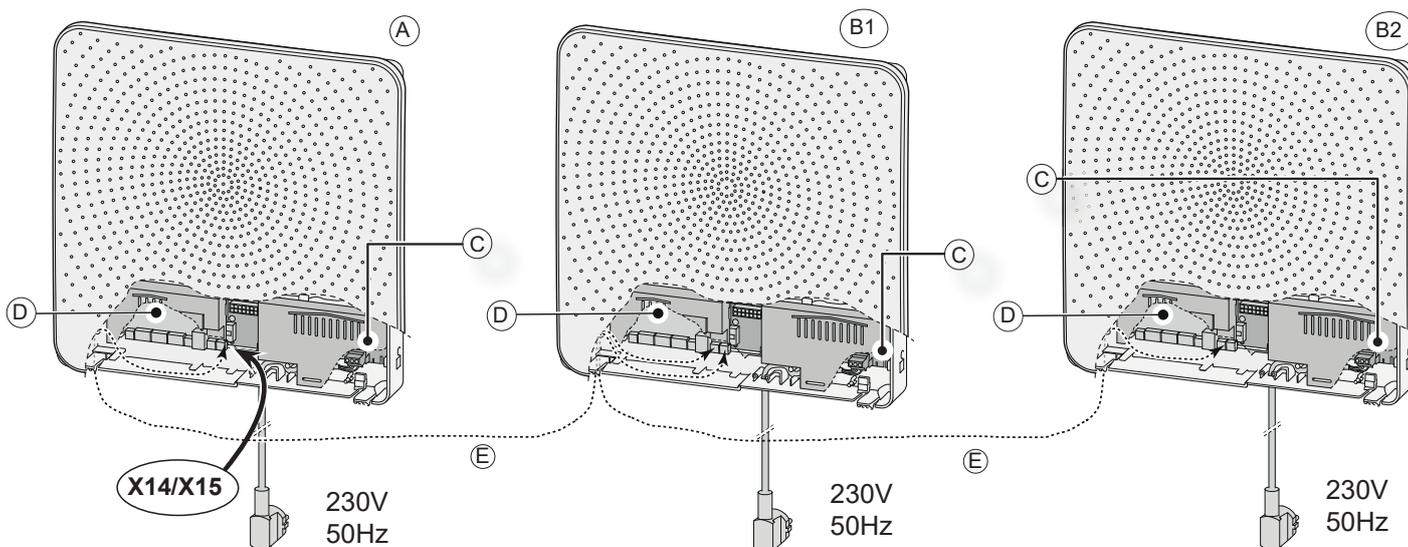
Die Lüftungsstufe des 'Master'-Geräts wird von den 'Slave'-Geräten übernommen
