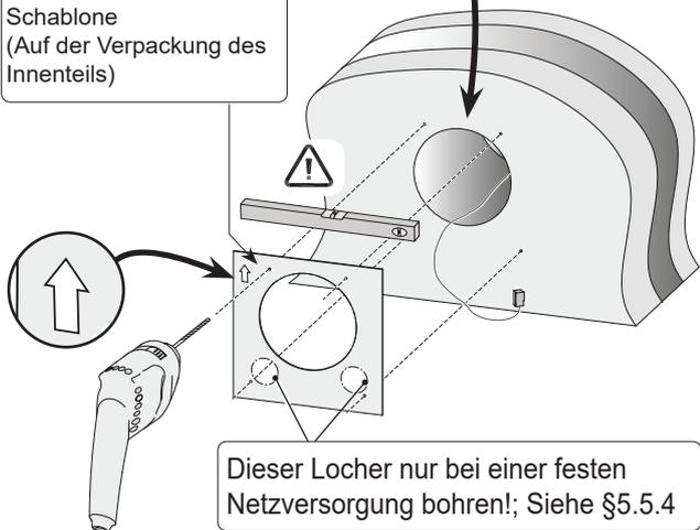
Dieser Locher nur bei einer festen Netzversorgung bohren!; Siehe §5.5.4
