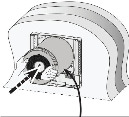
⚠ Kabel zur Frontabdeckung ordentlich in die dafür bestimmte Rille einführen!
