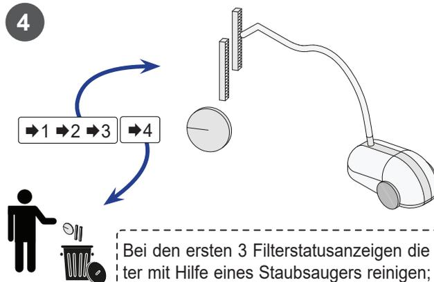
Bei den ersten 3 Filterstatusanzeigen die Filter mit Hilfe eines Staubsaugers reinigen; bei jeder 4. Filterstatusanzeige die Filter austauschen (mindestens 1x pro Jahr!)
