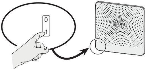
22 Den Filterzähler nachdem die Filter ausgetauscht/gereinigt worden sind (siehe dazu §8.1 Ziffer 7) zurücksetzen.
